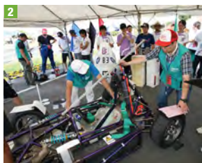
1 ステアリングは、切れ角が足りないという指摘を初日に受けていたので形状を大きく変更。2 初日の不備に対処したが模擬車検では、それでも足りずに不備を指摘された。車造りの難しさを実感する経験となった。3 車検場で実際と同じ内容が行われる模擬車検。ここまでの4日間で修正してきたマシンで臨んだのだが…。
