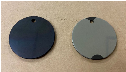
図4 Ni蒸着前(左)とNi蒸着後(右)のta-C
