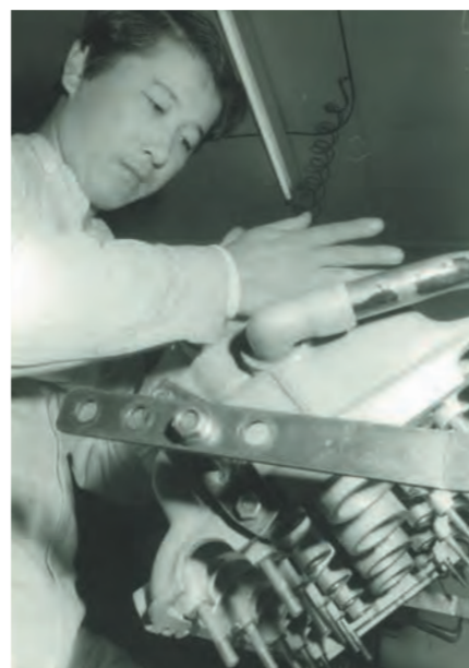
BMW M12のバルブ摺り合わせ作業
