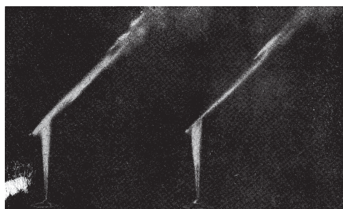
1920年代に撮影された壁面衝突ディーゼル噴霧 (常温常圧、噴射圧 5000[psi])
