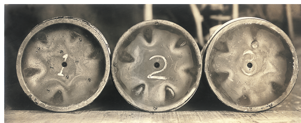
ピストンに燃料噴霧が衝突した痕跡 (TH554機関、シリンダ径220ミリ、ストローク350ミリ)
