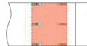
図2 ラップシエア継手のひずみゲージ貼付位置
