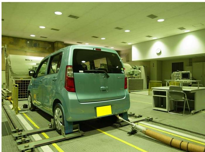
Fig.3 シャシダイナモに設置された試験車の(レンタカー)ワゴン R
