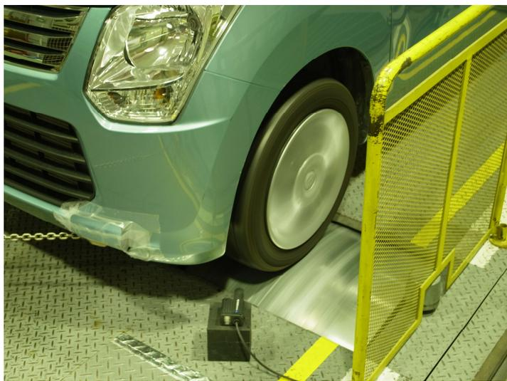
Fig.6 シャシダイナモの上で固定されたワゴン R の前輪
