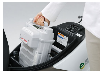
Figure 4-19 シート下に収納可能な E-LET'S の予備電池
