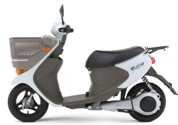
Figure 4-18 ホイールインモータ採用の電動スクータ、E-LET'S
