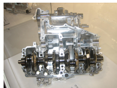
Figure 2-13 MotoGP用エンジンのクランクケースとクランクシャフト
