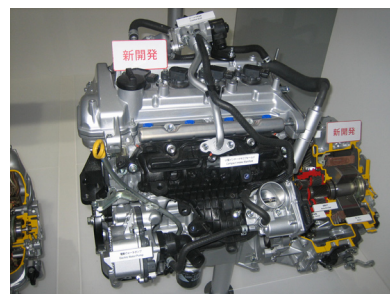
Figure 2-8 小型ハイブリッド車AQUA用エンジン
