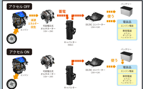
Figure 4-27 マツダの減速エネルギー回生システム, “i-ELOOP”
